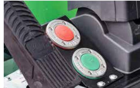
Bequeme Fußpedale zur stufenlosen Höhenverstellung der Kabine
