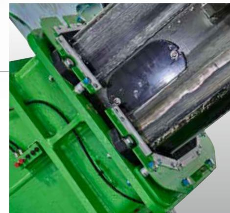
Gleitführungen des Teleskopauslegers sind von außen zugänglich - einfache Wartung und Fehlerbehebung.
