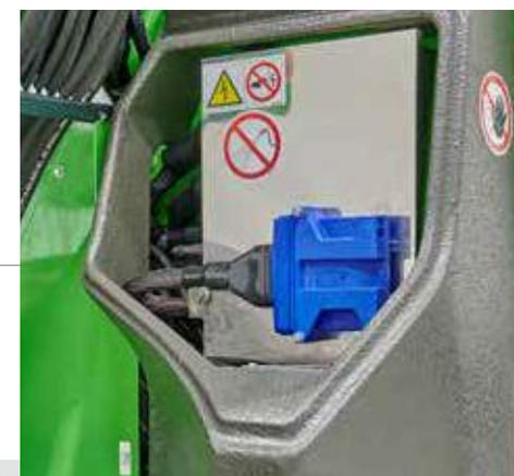
Optimale Zugänglichkeit zum Hauptsicherungskasten mit integriertem Übersichtsplan.
