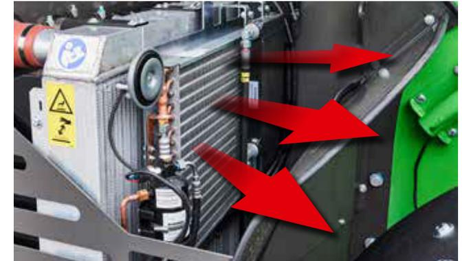
Der SENNEBOGEN 355 E arbeitet immer produktiv. Der serienmäßige und kräftige Umkehrlüfter sorgt zuverlässig für einen freien Lufteinlass und damit für die optimale Kühlleistung – auch unter schwersten Bedingungen.
