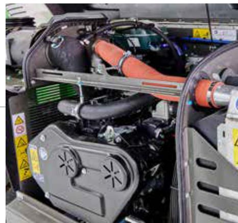
Einfacher Zugang zu allen Service-Punkten dank quer eingebautem Motor.
