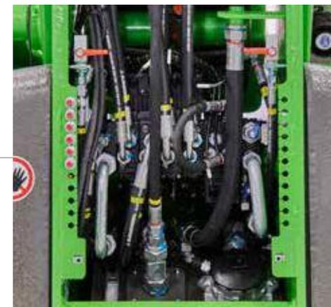
Bestmöglicher Zugang zum Hauptsteuerblock, Hydrauliköltank und Rücklaufilter.
