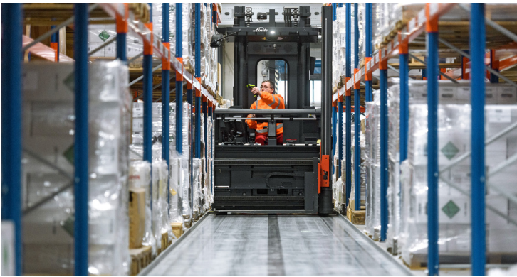
Die Paletten im FLN-Lager sind über Barcodes mit dem Linde Warehouse Navigator verheiratet. Auf Basis dieser Daten sorgt das System dann für eine optimale Verteilung der Fahraufträge.
